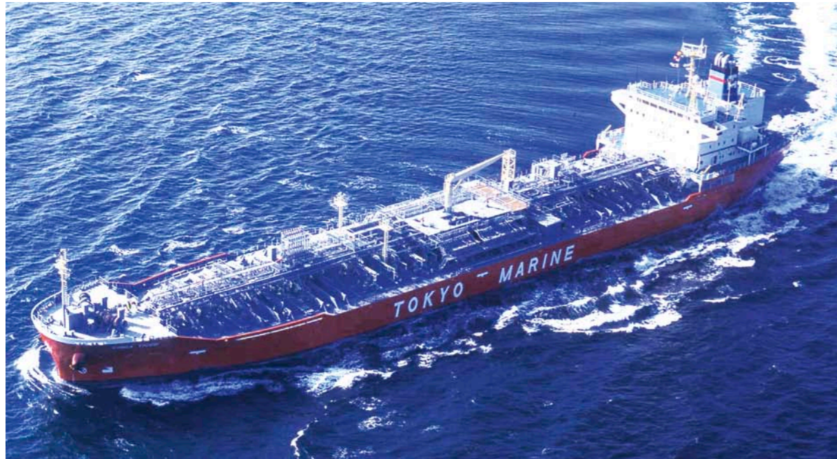
Chemical tanker (NSSC2120, 316L, 316LN, S31803, e.t.c.)
